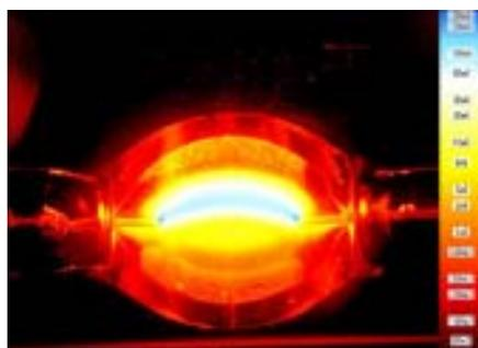
Gas discharge of a metal halide lamp (TU Berlin, Lichttechnik).
